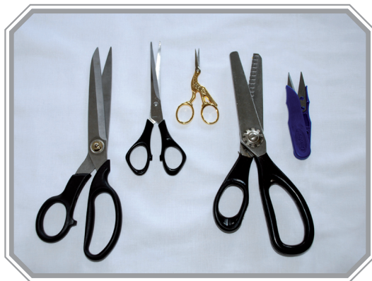
3 pav. Žirklys (žr. iš kairės į dešinę: 1) didelės siuvėjo nevienodomis geležtėmis ir kilpomis žirklys; 2) mažesnės žirklys vienodomis kilpomis, aštriais ir smailiais galais; 3) mažos žirklutės nerietais galiukais; 4) figūrinės, dantytai kerpančios žirklys; 5) specialios žirklutės siūlams nukirpti)
