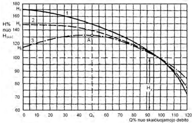
9 pav. Išcentrinių siurblių H-Q charakteristikų formos:
