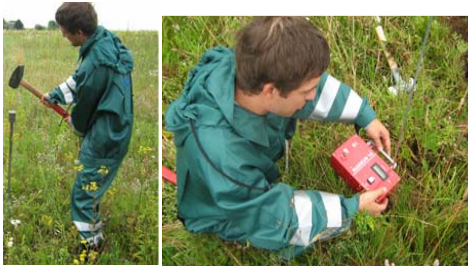
2.7 pav. Atliekami radono tūrinio aktyvumo matavimai grunto ore
