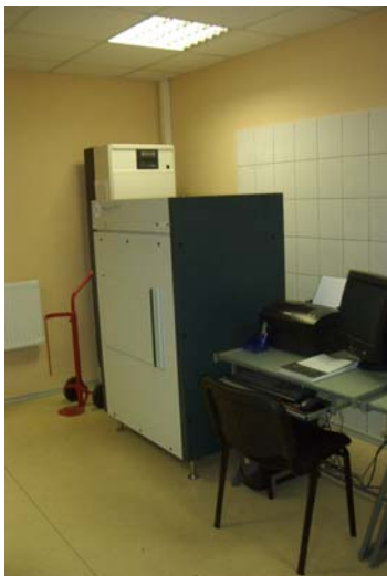
2.9 pav. Spektrometras Quantulus, kuriuo atlikti radono tūrinio aktyvumo vandenyje tyrimai
